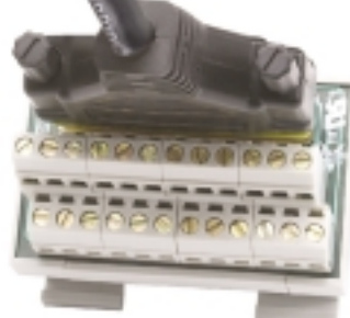
Выносной модуль на 16 дискретных каналов (ZL-CM056), подсоединенный кабелем (ZL-CBL056)
