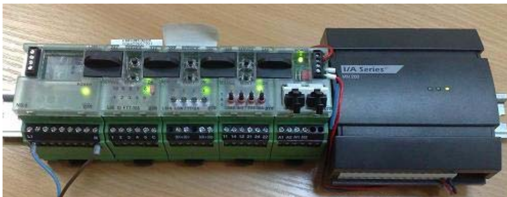
Пример подключения LON модулей BTR Logline к контроллеру MicroNet серии MNL
