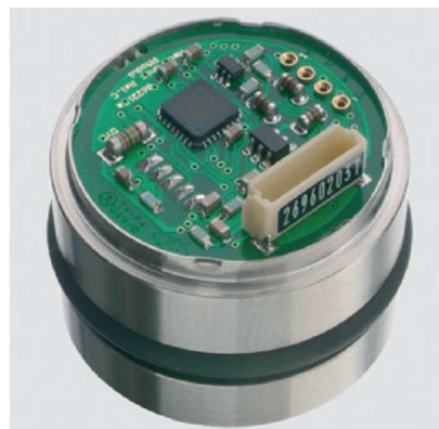
OEM версія датчика тиску та температури з ASIC Trafig. Датчик застосовується для визначення щільності палива
