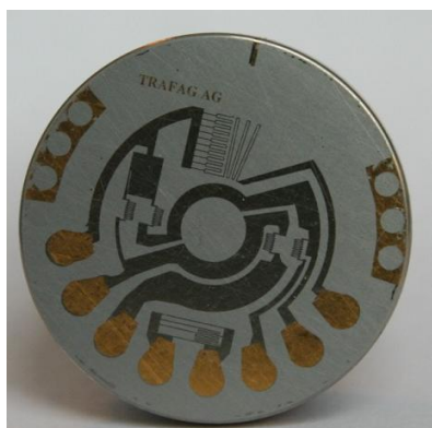
Сенсор тиску Trafig з структурою метал-діелектрик-метал
