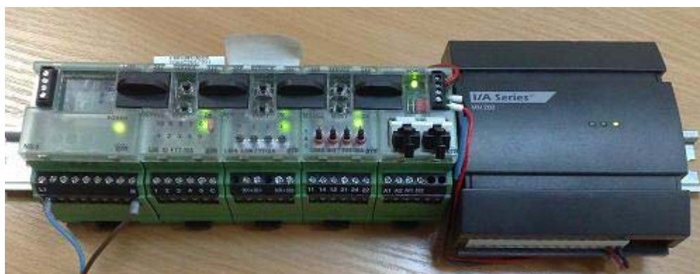
Компактные LON модули ввода/вывода Logline со свободно программируемым контроллером MN200 I/A Series
