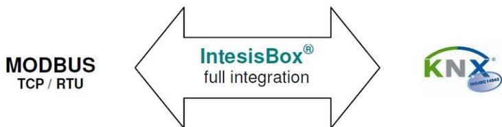
Шлюзы IntesisBox обеспечивают полную интеграцию сетей KNX и Modbus
