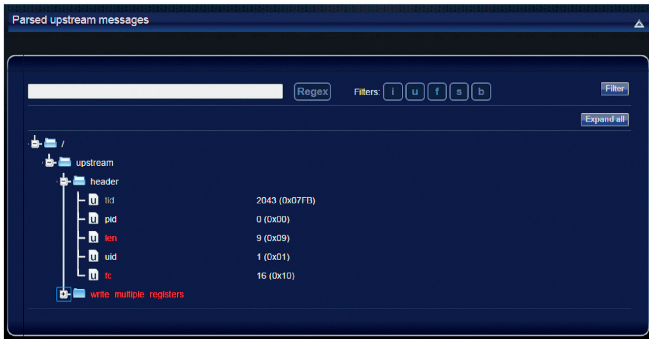
Мал. 3. Приклад повідомлення SilentDefense про підозрілу зміну значень в технологічному процесі по протоколу Modbus/TCP.
