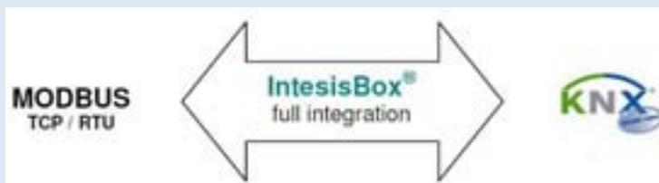
через драйвер Modbus. IntesisBox выступает в качестве еще одного устройства в системе KNX, всегда сохраняя в памяти обновление зеркала декларируемых значений KNX в своей таблице конфигурации, готовых для обмена с Modbus по запросу. Точки в сети KNX могут быть прочитаны и записаны через устройство Modbus мастер — контроллер, операторскую панель или систему SCADA.
