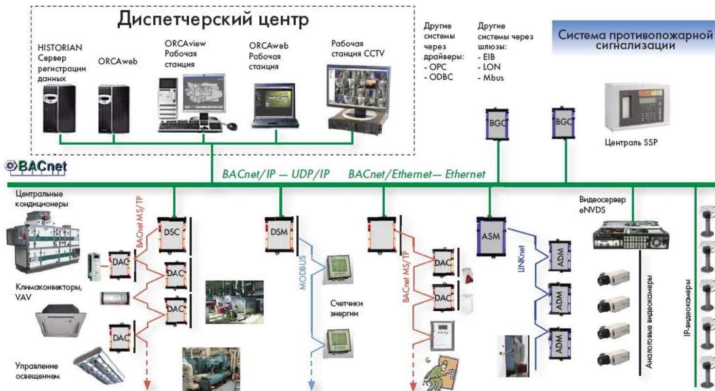
Автоматика систем ОВК (HVAC), мониторинг параметров среды, управление освещением, мониторинг ИБП (UPS), агрегатов и распредел. щитов
