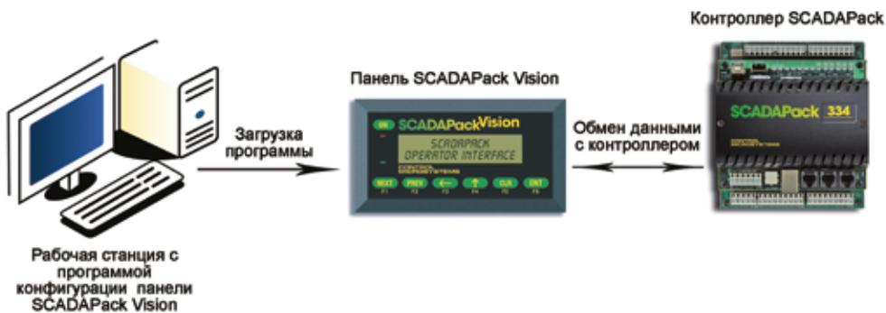
Имеются две модели операторских панелей: SCADAPack Vision10, SCADAPack Vision60, одинаковые по своей функциональности, но отличающиеся объемом памяти, размерами экрана и количеством программируемых клавиш.
