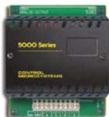
Модуль **5304** может работать как в режиме работы с токовыми выходами, так и с выходами напряжения, диапазон конфигурируется переключателями. В режиме работы с токовыми выходами модуль 5304 может вырабатывать сигналы 0 – 20 мА. В режиме работы с выходами напряжения модуль 5304 может вырабатывать сигналы 0 – 5 В или сигналы 0 – 10 В. Возможна установка смещенных диапазонов 4 – 20 мА, 1–5 В и 2–10 В.
