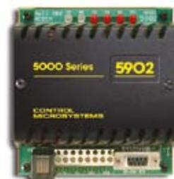
Модем 5902 совместим практически со всеми типами радиостанций. Для радиосвязи используется изолированный управляемый выход для включения радиопередачи и вход с обнаружением несущей радиочастоты. Этот вход может использоваться для запрещения передачи при обнаружении радиосигнала. Присутствует возможность настройки времени задержки определения несущей и времени задержки потери несущей, а также времени задержки RTS/CTS, что обеспечивает высокое качество передачи данных в различных условиях.
