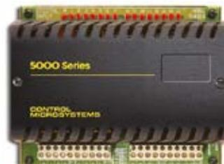
Дискретные входы оптически изолированы от питания логики. Для упрощения внешней проводки, входы разделены на группы по четыре ввода на один общий провод. Эти группы изолированы друг от друга.
