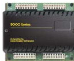
Имеется два стандартных диапазона напряжений модуля 5405: для постоянного и для переменного тока, которые определяются ограничительным резистором на каждом вводе. Этот резистор может быть изменен для обеспечения нестандартных диапазонов сигналов.
