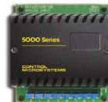
Данные модули позволяют вводить в систему автоматизации дискретные или аналоговые параметры в целях отладки и тестирования программ, проверки правильности алгоритмов. Также эти модули могут быть использованы как недорогие средства для ввода информации оператором.
