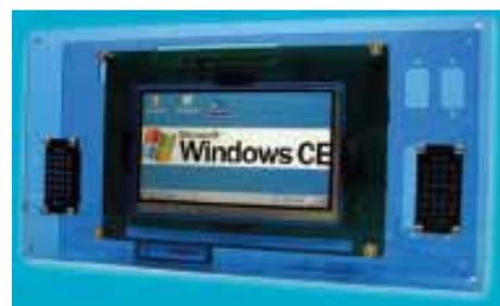
Контроллер системы может выполнять функции контроля параметров, управления внешними устройствами, регистрации и анализа данных, передачи данных по сети Ethernet LAN/WAN, GSM, GPRS и различным коммулируемым каналам связи.
