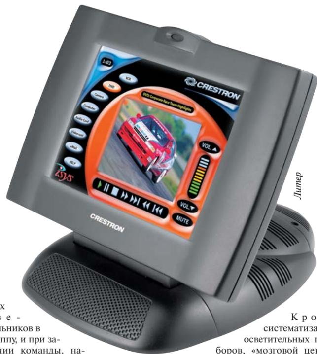
Кроме систематизации осветительных приборов, «мозговой центр» позволяет получать информацию и давать команды климатическим контроллерам. Они предоставляют данные о текущей и заданной температуре, режиме работы, в котором находятся устройства: нагрев, охлаждение, состояние присутствия или отсутствия хозяев.
