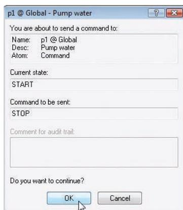
Рис. 9. Используя Безопасную Команду «Подтвердить» (Confirm), оператор может подтвердить выполнение команды
