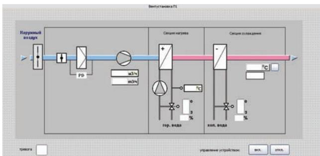
Рис. 4. Пример отображения мнемосхемы из целевой системы ISaGRAF
