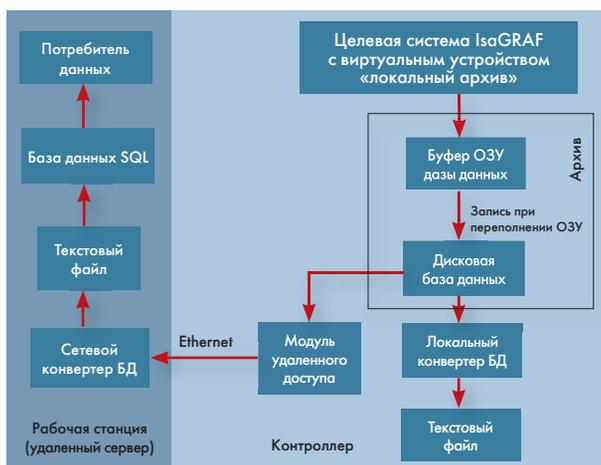
Рис. 2. Схема работы распределенной системы архивирования данных
