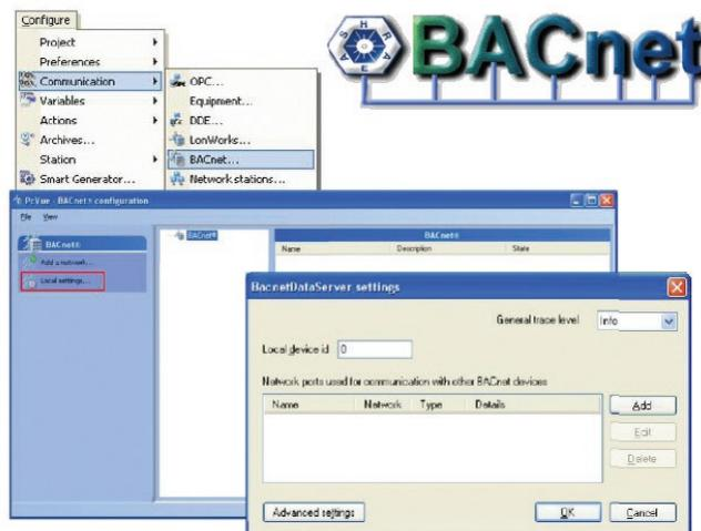
**Рис. 10.** В новую версию SCADA-системы PcVue 9.0 включена поддержка протокола BACnet на основе OPC-сервера Kerware
