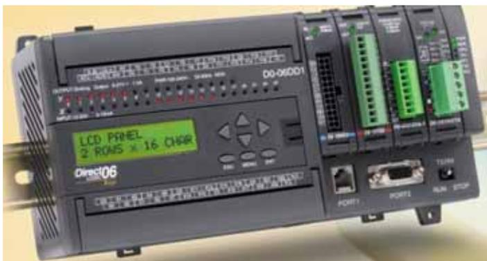
Контроллер поддерживает до 8 контуров ПИД-регулирования с автонастройкой, до 100 точек ввода/вывода, поддерживает арифметику с плавающей точкой. Имеет два коммуникационных порта, в том числе RS232/422/485. Обеспечена встроенная поддержка протоколов: Modbus RTU ведущий/ведомый, ASCII ввод/вывод и DirectNET
